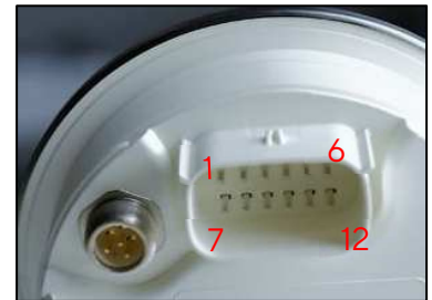
VMH 35 - Geräterückseite Molex MX150 12-poliger Stecker und DeviceNet 5-polig
